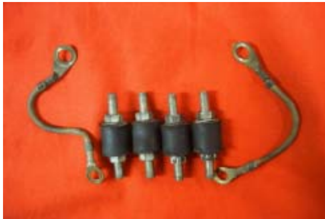
中央：ラバーマウント、両側：ダイオードボードのアース線
